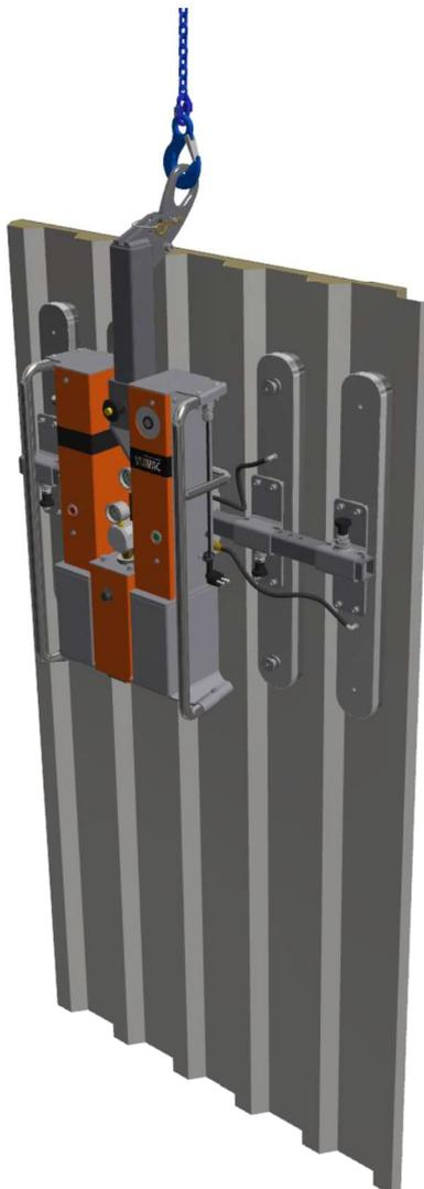
Figure 5.6 Cladboy compact Flex CBC3 avec bras de levage long et panneau.
